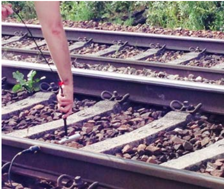
Abb. 2-3: Messung der Schienenabklingrate mittels Impulshammermethode
